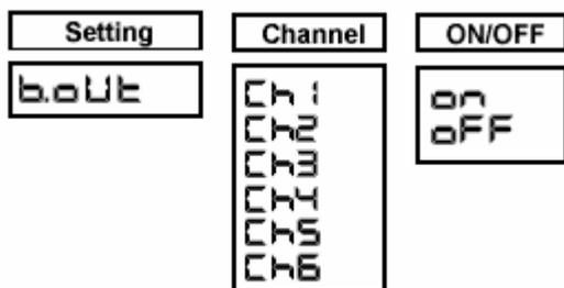
進入 ENG 階層後，利用 ▲ 鍵找到 B.OUT 參數，按 ENT 鍵可進入，再利用 ▲ 鍵可切換至欲設定之通道，按 ENT 鍵進入後，用 ▲ 鍵可切換 ON/OFF。設定完畢後再按一次 ENT 鍵可返回 B.OUT 參數，可利用 ▲ 鍵找到 END 參數，按 2 次 ENT 鍵即可返回正常顯示畫面。
