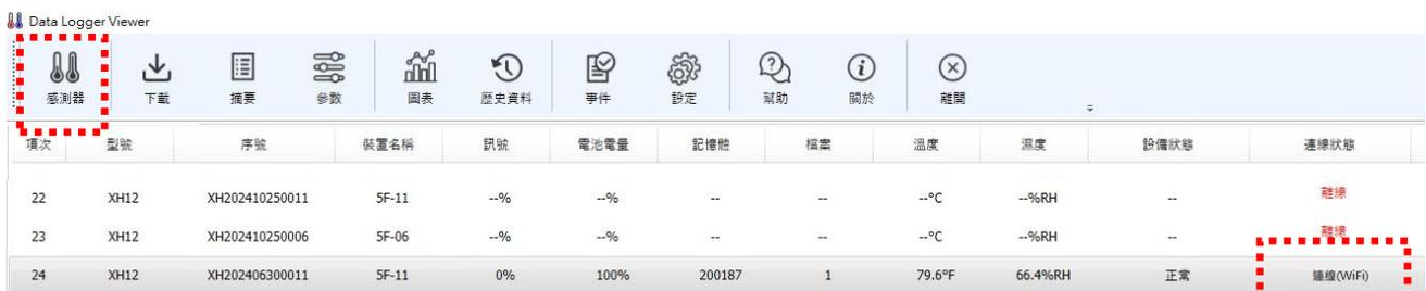
2) XH12 插上 USB 與電腦上 DLV 連線 · 下載資料備份。點選感測器 > XH12 名稱 > 下載。備份 DLV 資料 · 請備份 DLV 安裝目錄下的資料庫(C:\Data Logger Viewer\DataLogger.db).
