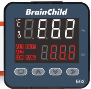
E62 PID 溫度控制器是專為調控溫度而設計。採用 PID 邏輯演算法使控制反應更快速、更穩定。透過標準Modbus RTU通訊，可佈建溫度控制節點，並把必要參數傳至 PLC或資料收集器(DAQ)。可支持常用的溫度輸入訊號，如熱電偶(J、K、T、R、S)和熱電阻(PT100)溫度傳感器。此外，它配備了紅、白雙色 LCD 顯示，查看溫度、警報狀況及設定參數一目了然，並優化設定參數介面。如有特殊環境或設備應用，可選購IP65 增加防護功能。E62以更有競爭力的價格滿足各種溫度控制需求。
